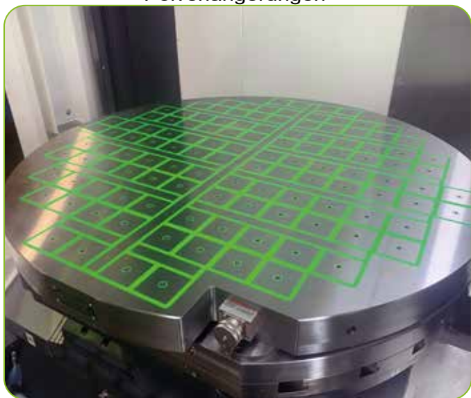
FXL-R Magnetspannplatte auf einem Bearbeitungszentrum mit Drehtisch D=1250mm
