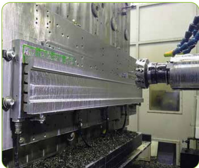
Fräsen von Führungsbahnen, gespannt in vertikaler Spannung auf mobilen Polverlängerungen
