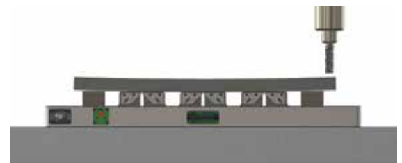
Kippelfreie Dreipunktauflage mit 3 festen Polverlängerungen und mobilen Polverlängerungen für die automatische Anpassung an das Werkstück.
