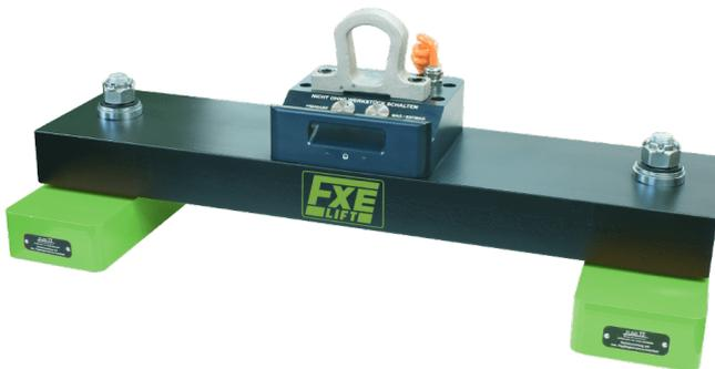
FXE-T2500/50 und 4000/80 Elektro-Permanent Lasthebemagnettraversen in kompakter Bauform mit onBoard Steuerungstechnik sind konzipiert für den häufigen Umschlag von größeren Formaten. Sie können, wie FXE Lasthebemagnete, direkt an Netzspannung betrieben werden und sind somit sehr schnell installiert und einsatzbereit. Die Ansteuerung erfolgt direkt am Gerät oder optional über eine Fernbedienung.
