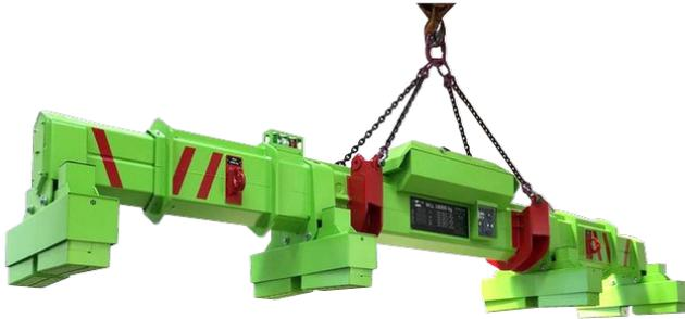
FXE-TT Teleskoptraversen sind mit elektrohydraulischen Teleskop-Armen ausgestattet und eignen sich für das Handling von Blechen von 3-16m Länge.
